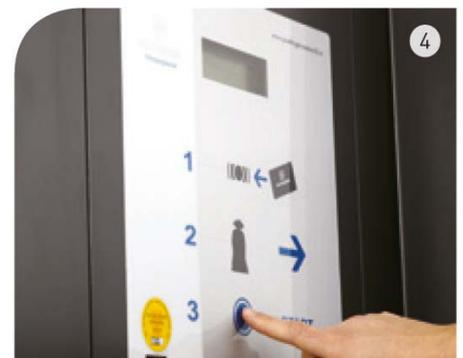
Mit der eingebauten Wiegetechnik können die jeweiligen Abfallmengen berechnet und die diesbezüglichen Entsorgungskosten auf die Transponderkarte gebucht werden. Die Abrechnung erfolgt dann mittels Vorschreibung.
